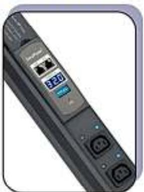
InfraPower 切換型MTS系列電源模組是專為重要的資料中心及遠端電源管控而設計,使用者可以透過CyberView Cat6 IP KVM從遠端管控MTS電源模組上個別插座的開啟/關閉。利用Cat6網路線最多可串接16台MTS,透過單一IP位址管控模組狀態。
